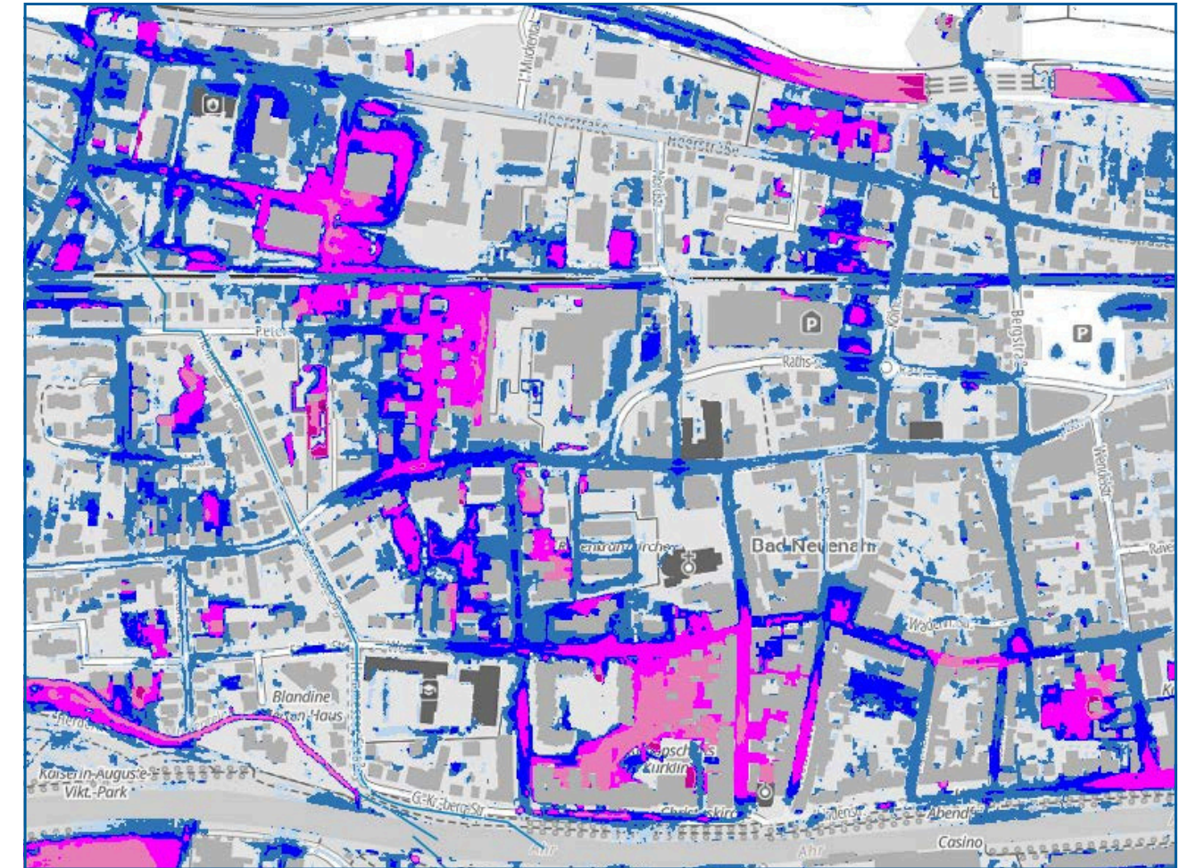
Sturzflutgefahrenkarte im Bereich zwischen der Heerstraße und der Ahr im Szenario „SRI 7, Regendauer: eine Stunde“. Quelle: https://wasserportal.rlpumwelt.de/auskunftssysteme/sturzflutgefahrenkarten .
