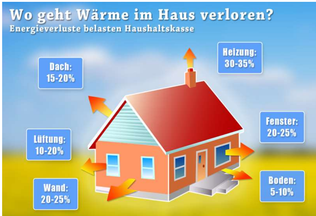
Abbildung 4-4: Energieverluste bei der Wärmeversorgung bestehender Wohngebäude 54
